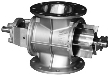
図11 両持サニタリ形（ロータ抜き形）
